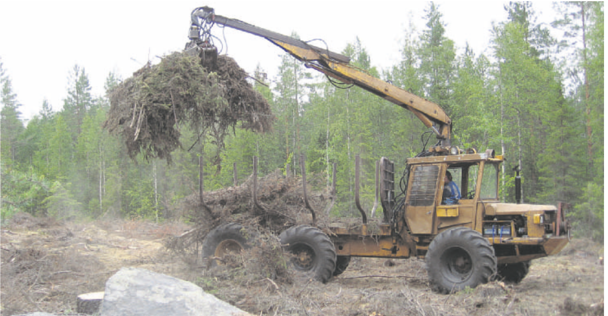
Metsähakkeen keruu on nopeaa, kun puut on karsittu kasoihin, josta hakkuutähteet kerätään niiden hieman kuivuttua. Kuvassa hakkuutähteiden keruuta Kaavin Niinivaarassa.
